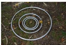
L'anode de diamètre de 600mm sera choisie pour une plus grande portée ou pour de l'eau douce de faible conductivité. De plus, un grand diamètre diminue la zone de tétanie se trouvant proche de l'anode. La pêche électrique est donc plus indolore pour les espèces avec une anode de grand diamètre. Cependant, lors de fort courant d'eau sa manipulation devient difficile.
